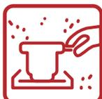
Lixar com lixa 80 ou lixa 150. Em seguida limpar a peça com Solução Desengraxante Maxi Rubber
